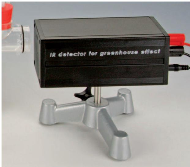
Denne detektor er specielt konstrueret til undersøgelse af absorption af infrarød stråling i CO<sub>2</sub>. Følsomheden er størst i et smalt bølgelængdeområde, som omfatter det interval, hvor CO<sub>2</sub> har et kraftigt absorptionsbånd.
