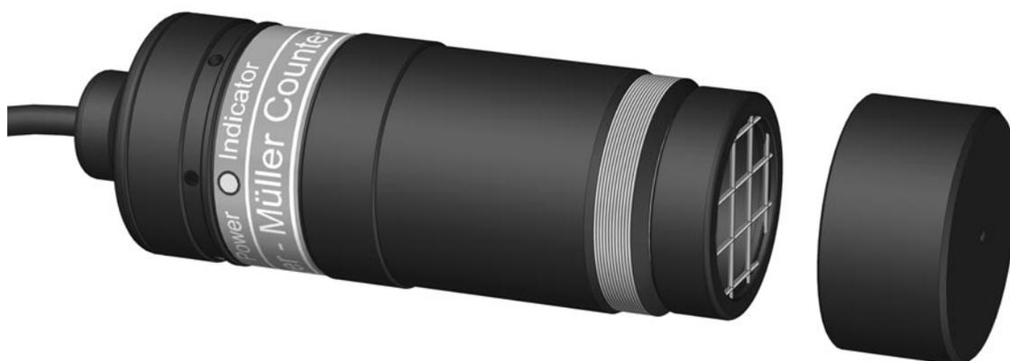
Denne GM-sensor er beregnet til måling af alfa, beta og gammastråling. GM-røret har et ekstra stort vindue, hvilket gør sensoren velegnet til måling på kilder, der normalt giver et meget lille tælleantal.
