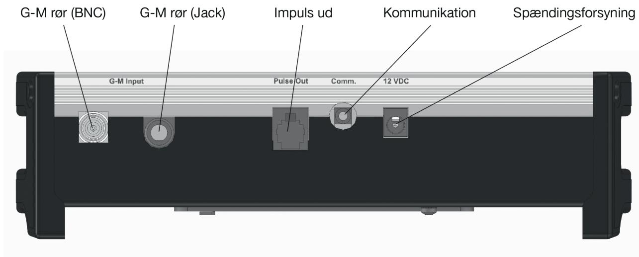
Der kan tilsluttes enten et G-M rør (BNC-stik) eller en G-M sensor med indbygget elektronik (Jack-stik). Almindelige G-M rør er det naturlige valg, men har man en G-M sensor, kan den også bruges.
