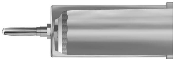
Kuglefangen er beregnet til eksperimenter med impulsbevarelse og monteres i enderne af en vogn til en luftpudeskinne. Der er to kuglefang i sættet af hensyn til vognens balance.
