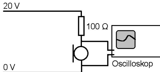
Såvel forsyningsspænding som belastningsmodstand kan varieres, hvorved mikrofonens dynamiske område ændres.
