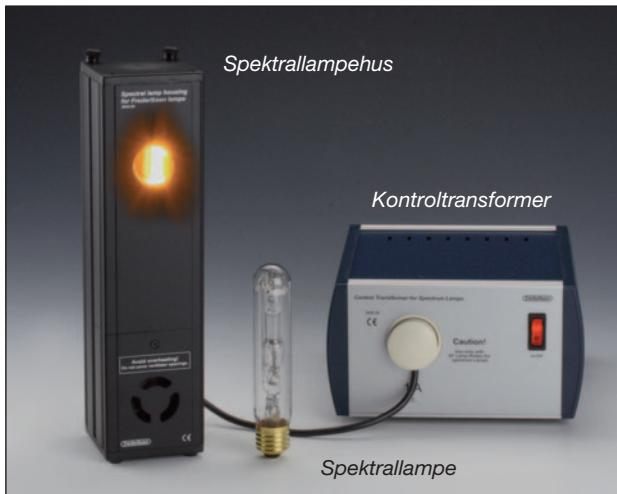
Dette spektrallampehus er designet til brug med spektrallamper med E-27 skruefatning. Disse spektrallamper må ikke tilsluttes lysnettet, men kræver en speciel strømforsyning, type 2840.50. Spektrallampehuset er forsynet med ventilator som sikrer, at spektrallampehusets overfladetemperatur ikke overstiger 60 °C.
