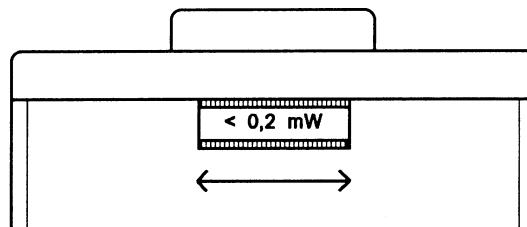
He-Ne laseren er et solidt og kompakt instrument med en udgangseffekt på 0,5 - 1 mW (typisk 0,9 mW). Som følge af den kompakte opbygning er laseren let at håndtere i laboratoriet. Laseren kan anbringes direkte på et solidt underlag eller fastspændes i en optisk bænk eller lignende. Til opspænding medfølger 2 stk. opspændingstappe, der kan monteres i gevindhullerne i laserens bund.
