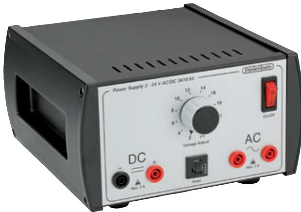
Strømforsyning nr. 3610.65 kan levere fra 2 til 24 V jævn- og vekselspænding med en strømstyrke på op til 5 A. Spændingen kan justeres i trin på 2 volt ad gangen.
