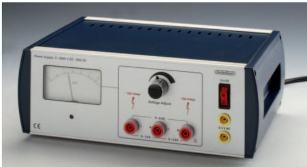
Højspændingsforsyningen nr. 3660.50 leverer en trinløs regulerbar jævnspænding fra 0 til 6000 V (6 kV), max. 2 mA. Udgangen for 6 kV er i midten og så forsynet med udtag for spændinger fra 0 til  $\pm 3$  kV. Kuben er desuden forsynet med en særskilt 6,3 V - 3 A vekselspændingsudgang for glødetråd i udladningsrør.
