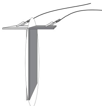
terpapiret. Systemet danner nu et galva- nisk element. For- bindes elektroderne til den letløbende motor nr. 5015.00 vil denne måske be- gynde at rottere. Hvis ikke fjernes den ene elektrode fra filterpa- piret og efter en kort udluftning på 5-10 s anbringes den igen.
